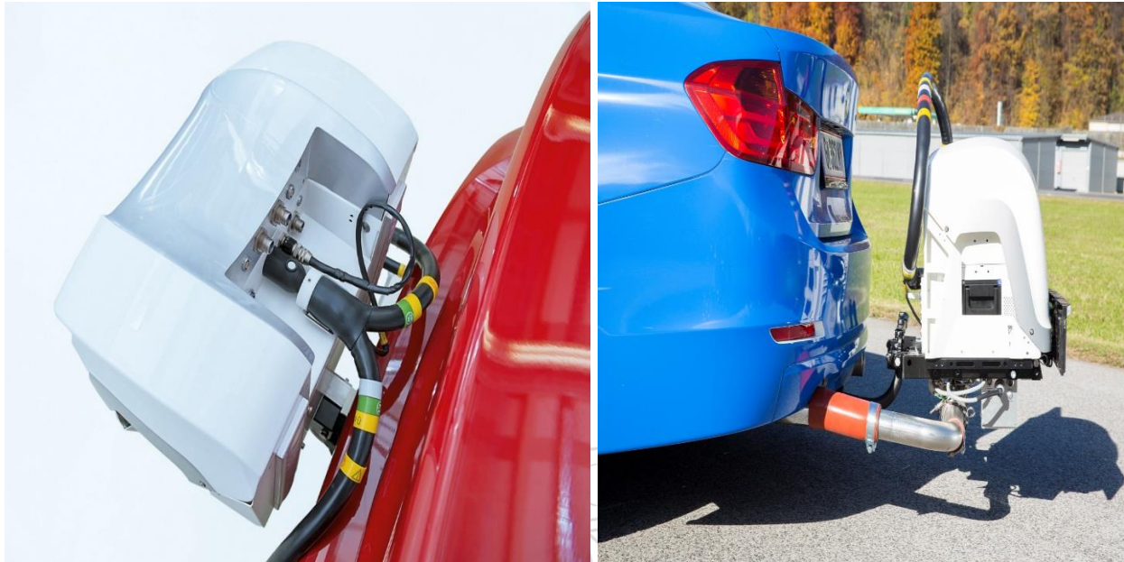
Abbildung 3: Typische Installation des AVL-Systems mit Gehäuse an der Anhängerkupplung
